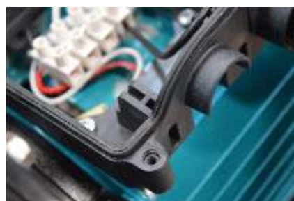
Caixa de ligação hermeticamente fechada
